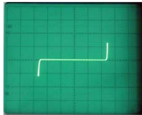
รูปที่ 18 การเปิดวงจรในการทดสอบไอซี
