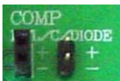
รูปที่ 3 ช่องใส่อุปกรณ์แบบสองขาและขั้วต่อสาย
