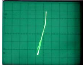
รูปที่ 17 การลัดวงจรในการทดสอบไอซี
