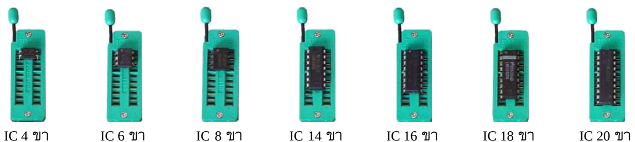
รูปที่ 16 ช่องสำหรับใส่ไอซีแบบต่างๆ และลักษณะในการใส่ไอซีเพื่อทำการทดสอบ
