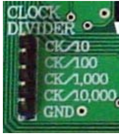
รูปที่ 5 ขั้วต่อสายสำหรับสัญญาณนาฬิกาที่ผ่าน การหารความถี่
